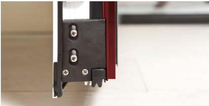
Verstellbar. Das Türsystem AT 85 verfügt über einen verstellbaren Fußpunkt. Dieser kann ca. 5 mm nach oben oder unten verstellt werden und bietet damit die Möglichkeit, Unebenheiten, Undichtigkeiten oder einfach nur der Fußmatte aus dem Weg zu gehen.
