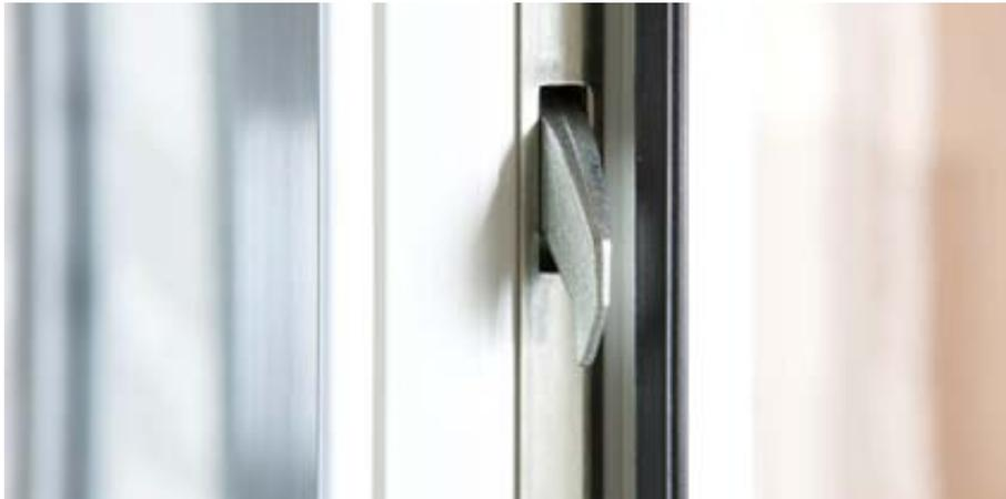
Jede Tür wird mit Massivschwenkriegeln aus Stahl ausgestattet. Diese greifen in Verschlussstellung nicht nur tief in die Schließleiste ein, sondern hinterkrallen sie gleichzeitig im Rahmen. Dies leistet einen wesentlichen Sicherheitsbeitrag gegen das Auseinanderziehen von Türrahmen und Türblatt.
