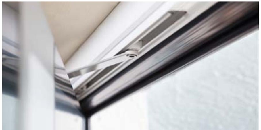
Intelligente Lösung bei geringen Platzverhältnissen. Der verdeckt liegende Obentürschließer ITS 96 verschwindet vollständig in der geschlossenen Tür. Die Tür wird nach jedem Öffnungsvorgang automatisch zugezogen, kann jedoch auch in einer gewünschten Öffnungsposition festgestellt werden.
